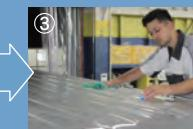
セラミック粘土を使用して鉄粉、水垢取り作業
